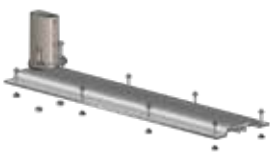
Placa de montaje para barandilla en chapas metálicas con paso de 250 mm paralelo a la chapa Entregado ensamblado - Fijación a la cubierta por 8 tornillos Drillnox DBS2 + arandelas de sellado
