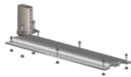
Placa de montaje para barandilla en chapas metálicas con paso de 333 mm paralelo a la chapa Entregado ensamblado - Fijación a la cubierta por 6 tornillos Drillnox DBS2 + arandelas de sellado
