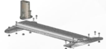
Placa de montaje para barandilla en chapas metálicas con paso de 333 mm perpendicular a la chapa Entregado ensamblado - Fijación a la cubierta por 6 tornillos Drillnox DBS2 + arandelas de sellado
