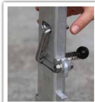
4. Enganche la perilla en la carcasa soltando la manija (la carcasa está equipada con muescas de bloqueo), para bloquear por completo la posición vertical, luego empuje la perilla hacia afuera hasta la última muesca. El sistema está entonces completamente bloqueado.
