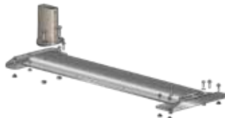
Placa de montaje para barandilla en chapas metálicas con paso de 250 mm perpendicular a la chapa Entregado ensamblado - Fijación a la cubierta por 6 tornillos Drillnox DBS2 + arandelas de sellado
