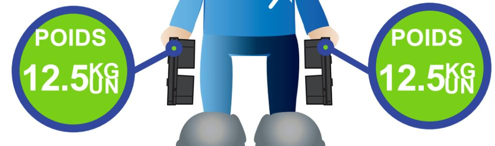
La charge est divisée en deux et des poignées conséquentes facilitent la préhension et l'usage. Le centre de gravité de MONPTI'PLO se situe au plus proche du corps de l'opérateur, le plot est facilement préhensible.
